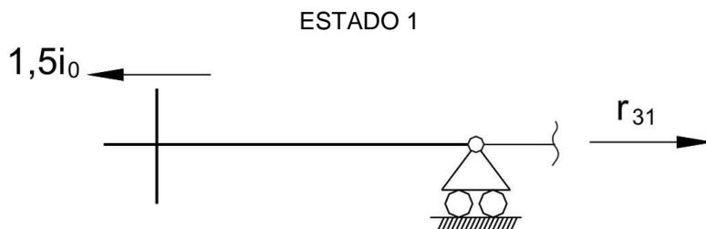
Las fuerzas cortantes en las barras cortadas se determinan, de acuerdo al diagrama de momento flector. Por ejemplo, para el estado 1, en la barra 1-2 se tiene  $V_{12} = -\frac{4i_0 + 2i_0}{4} = -1,5i_0$  y en la barra 2-3  $V_{23} = 0$ .
